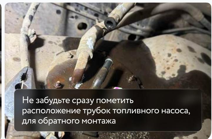
Не забудьте сразу пометить расположение трубок топливного насоса, для обратного монтажа
